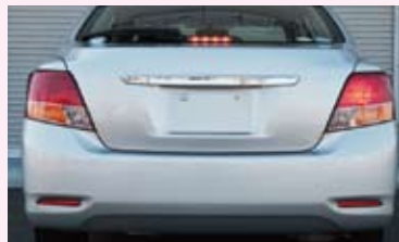
電球が切れたため点灯しないブレーキランプ
