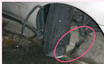
破損した前輪と車体をつなぐ装置
