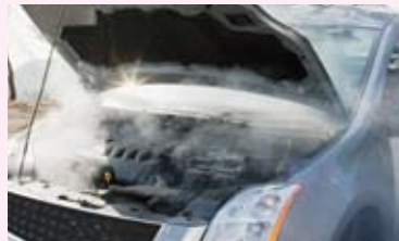
冷却不良によるオーバーヒート
